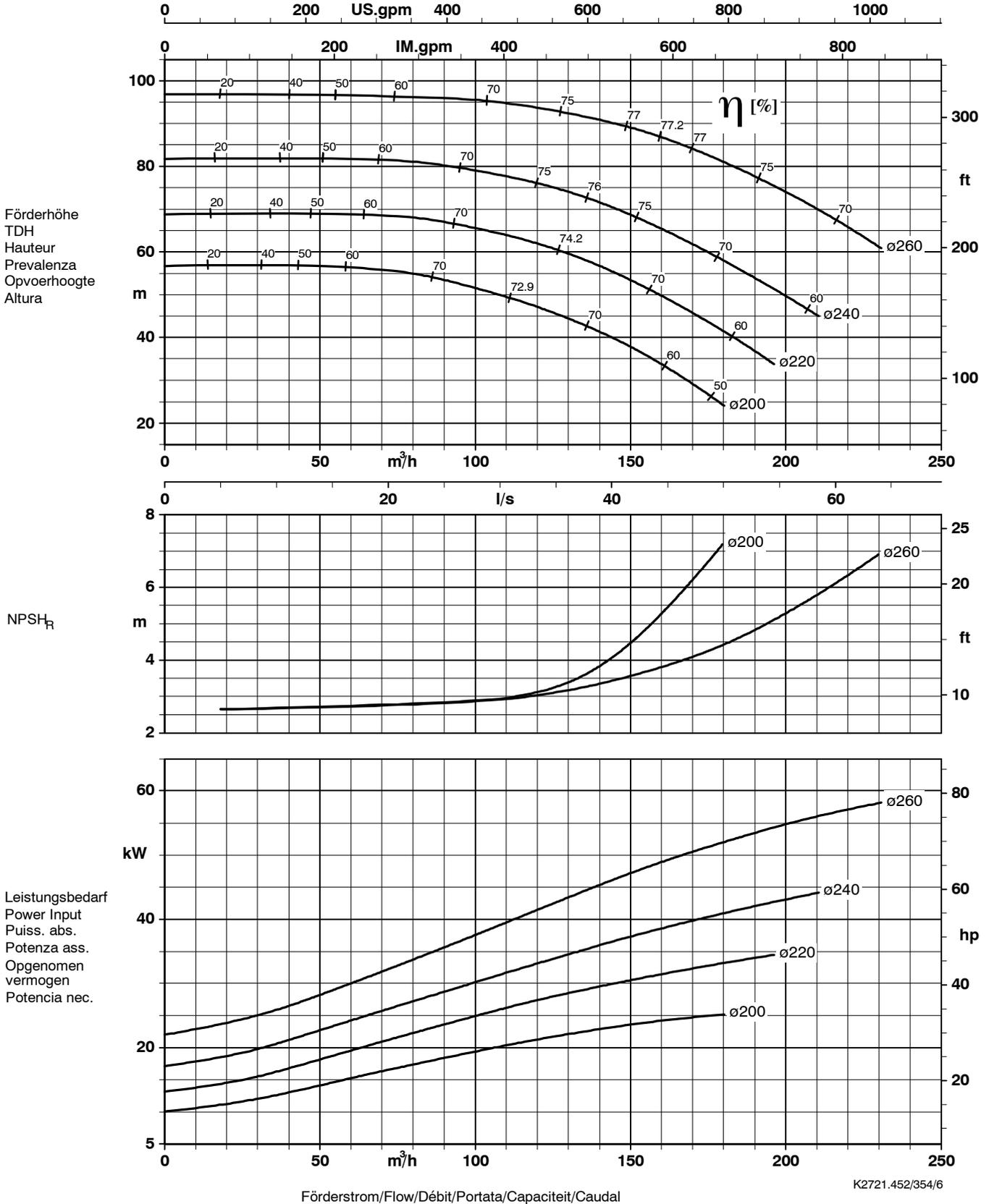
Laufradaustrittsbreite/Impeller outlet width/Largeur à la sortie de la roue 17 mm
