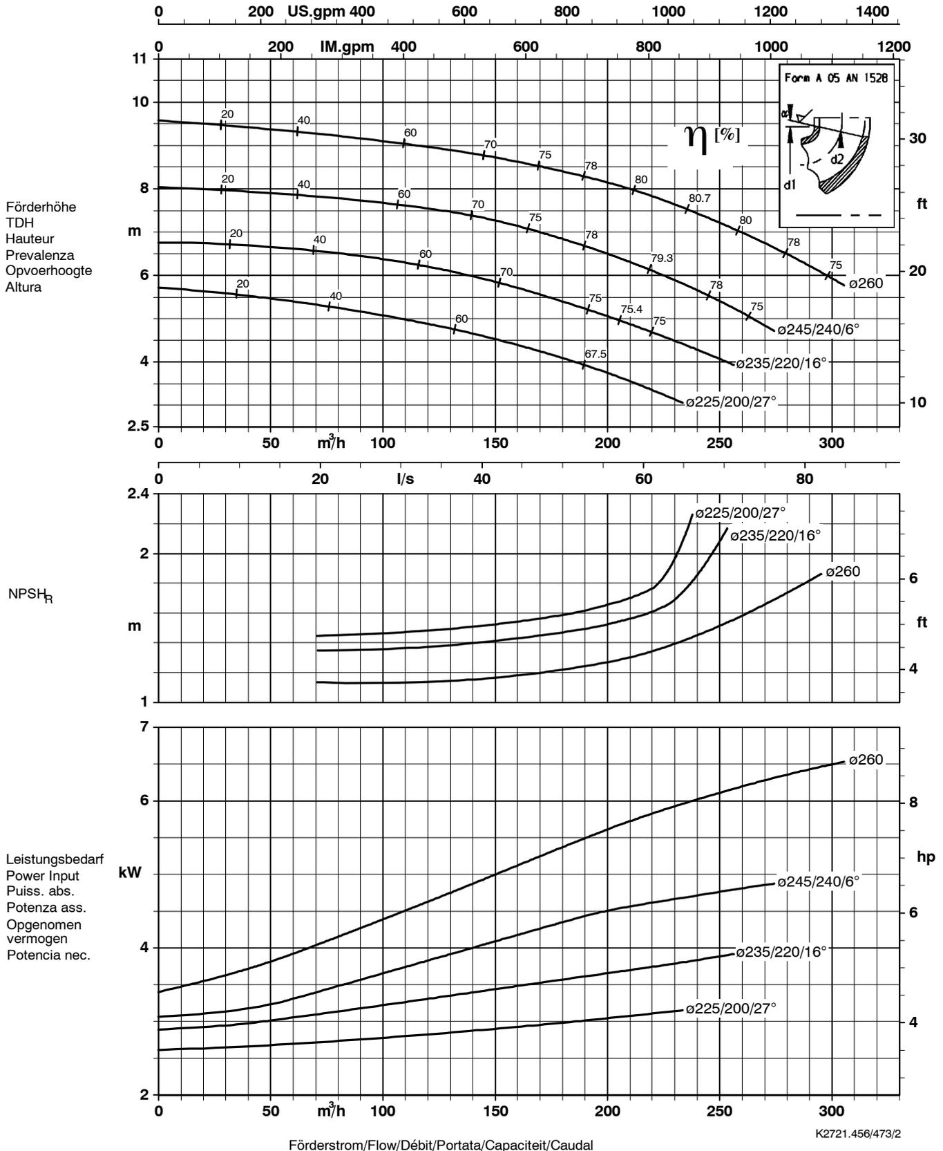
Laufraustrittsbreite/Impeller outlet width/Largeur à la sortie de la roue 46 mm
