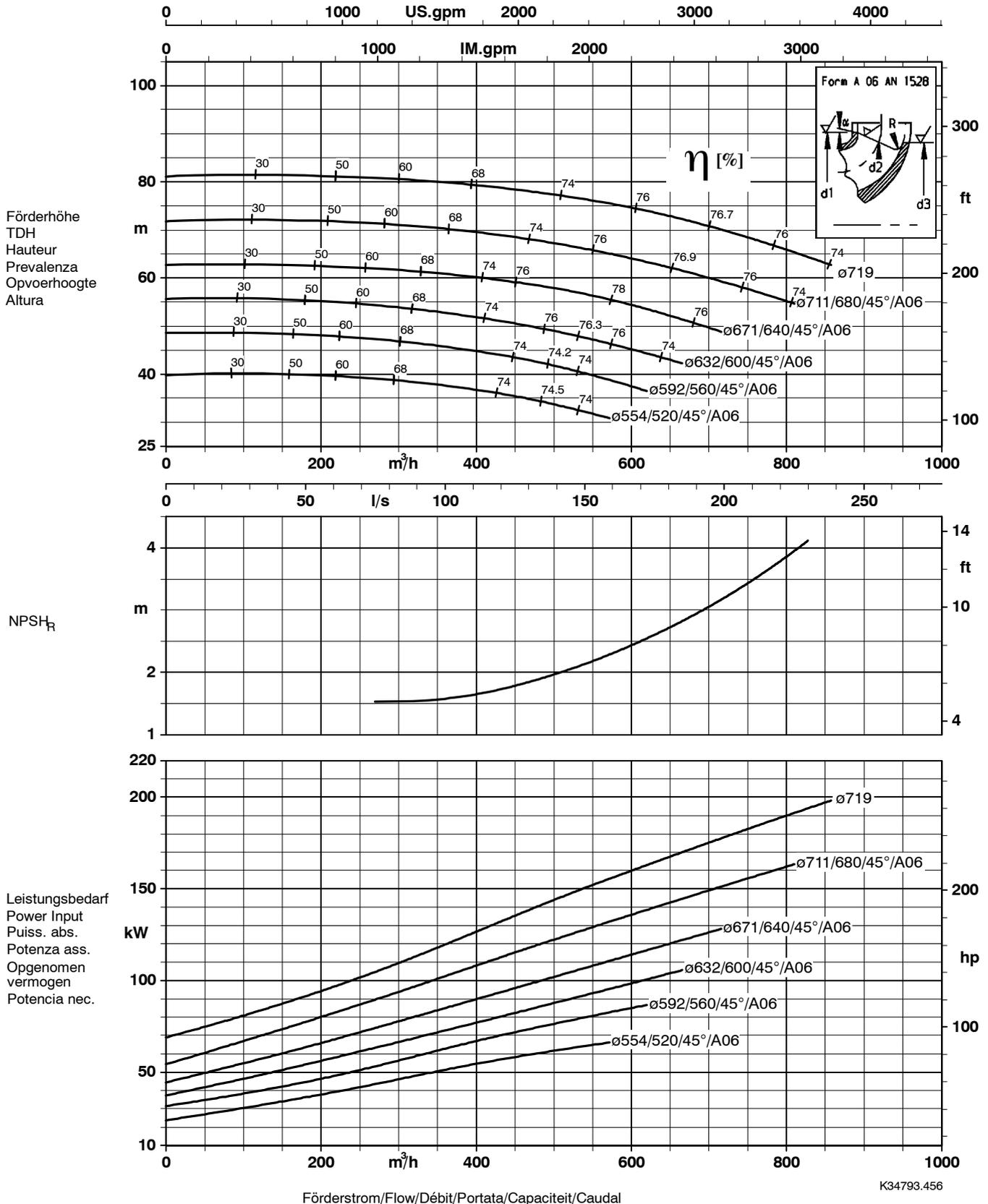
Laufraustrittsbreite/Impeller outlet width/Largeur à la sortie de la roue 38 mm
