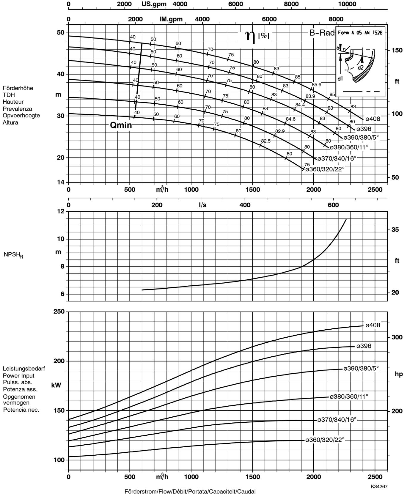
Laufradaustrittsbreite/Impeller outlet width/Largeur à la sortie de la roue 99 mm
