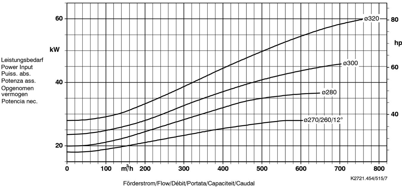
Lauftradaustrittsbreite/Impeller outlet width/Largeur à la sortie de la roue 50 mm
