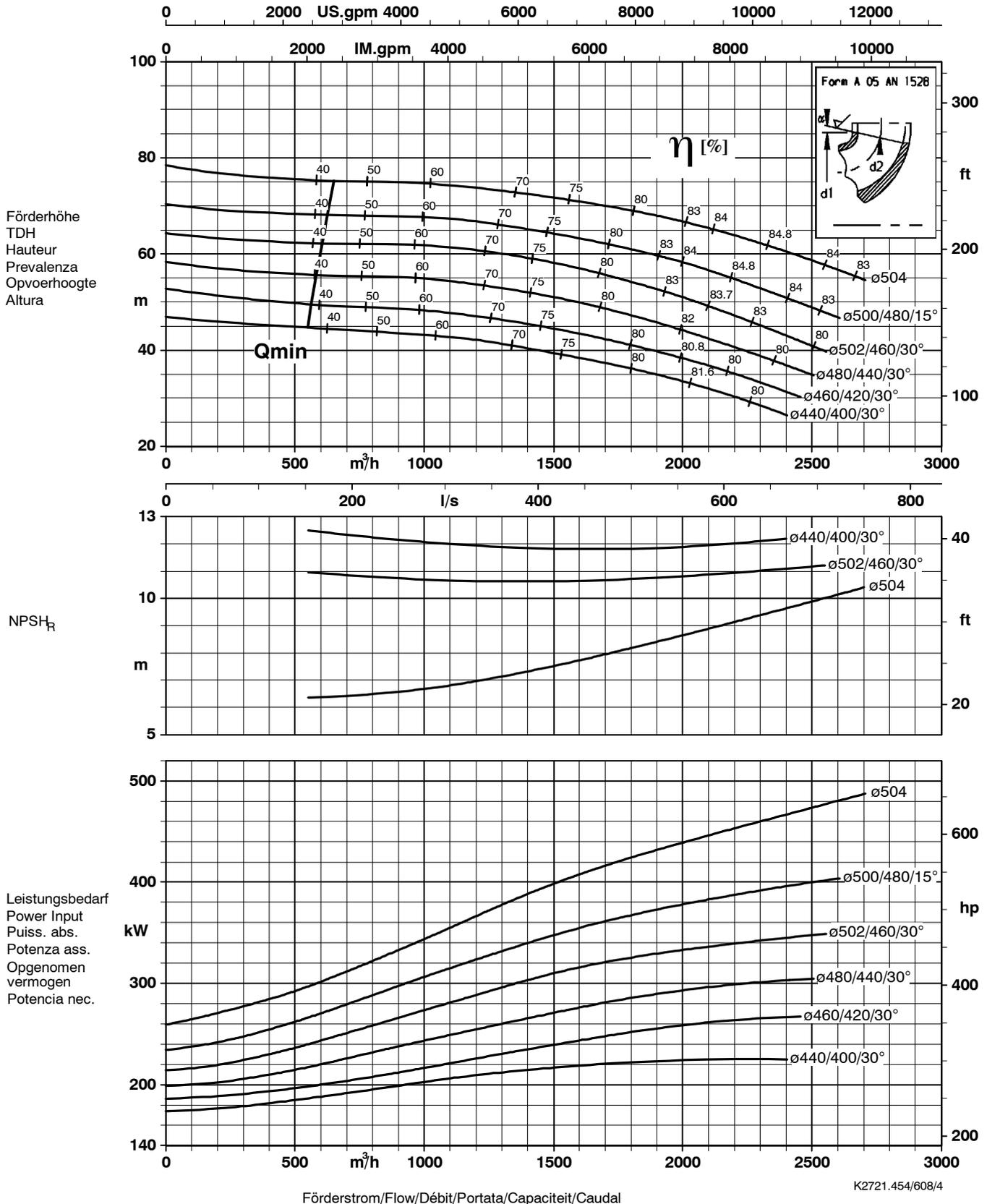
Laufraustrittsbreite/Impeller outlet width/Largeur à la sortie de la roue 72 mm
