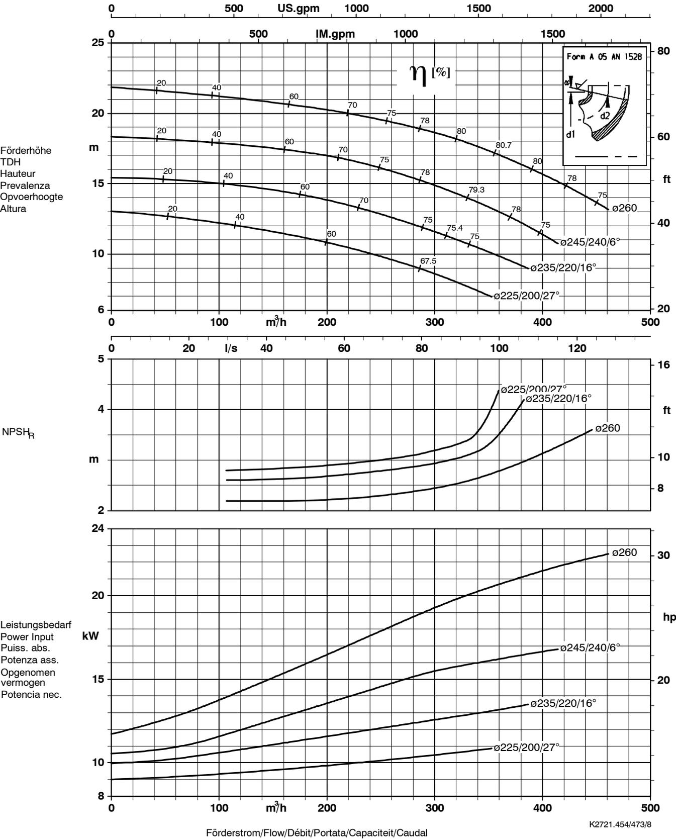
Laufradaustrittsbreite/Impeller outlet width/Largeur à la sortie de la roue 46 mm
