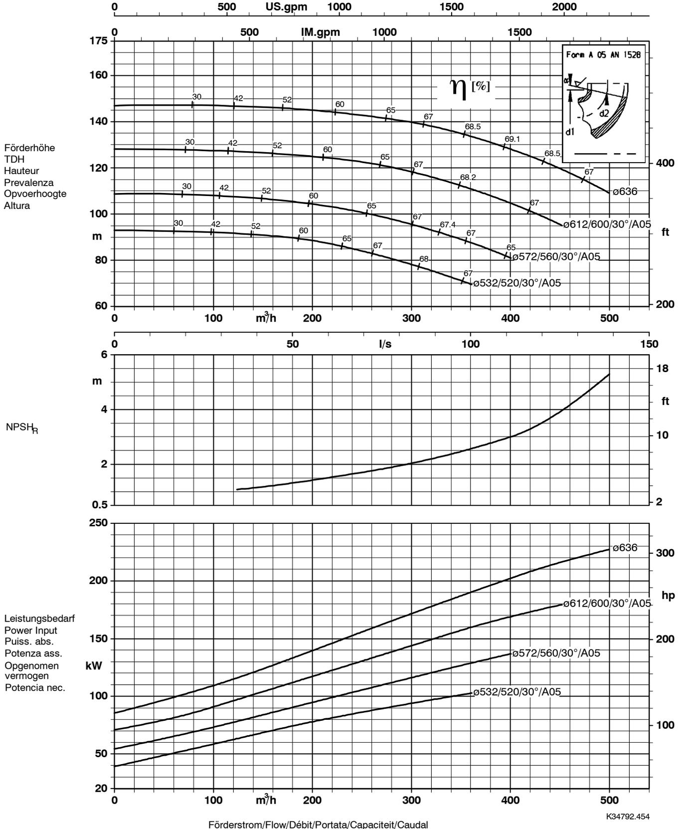
Laufraustrittsbreite/Impeller outlet width/Largeur à la sortie de la roue 21 mm
