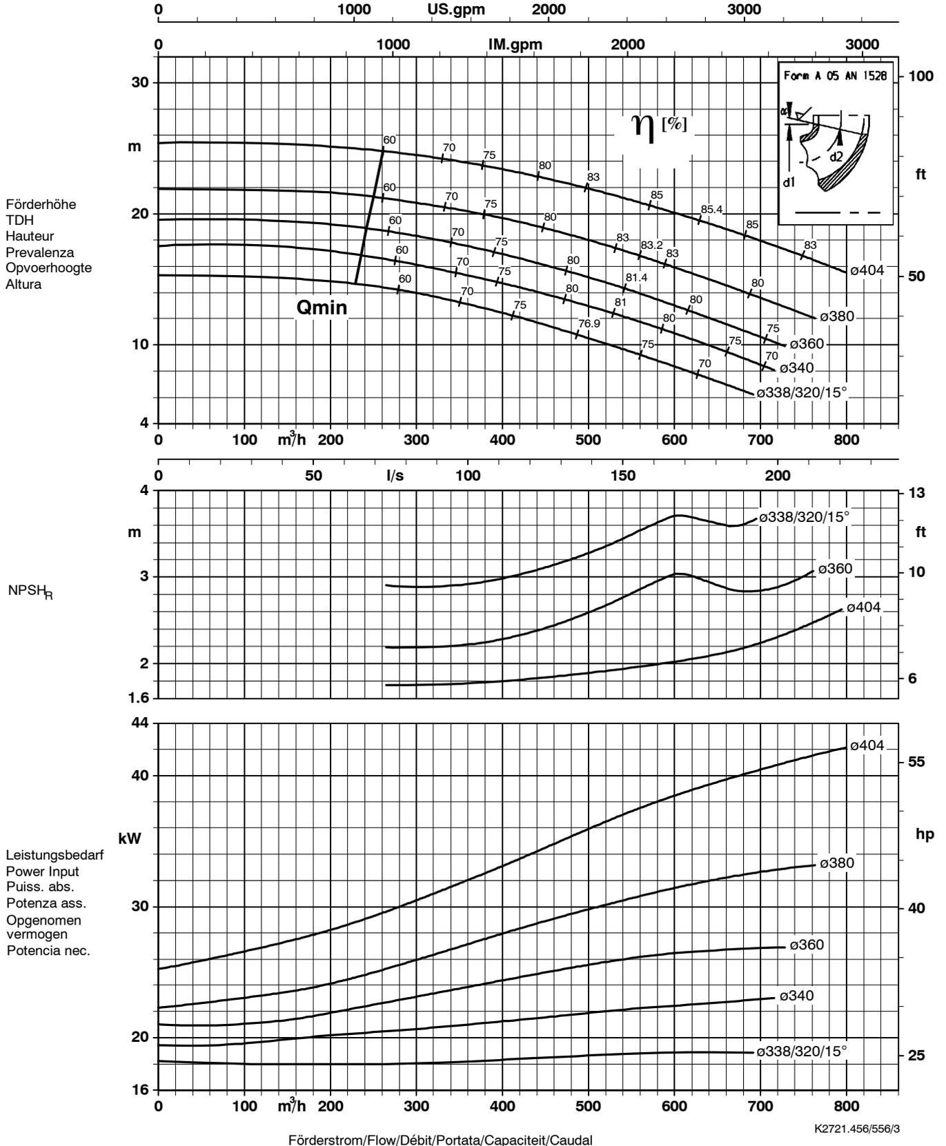
Lauftradaustrittsbreite/Impeller outlet width/Largeur à la sortie de la roue 63 mm
