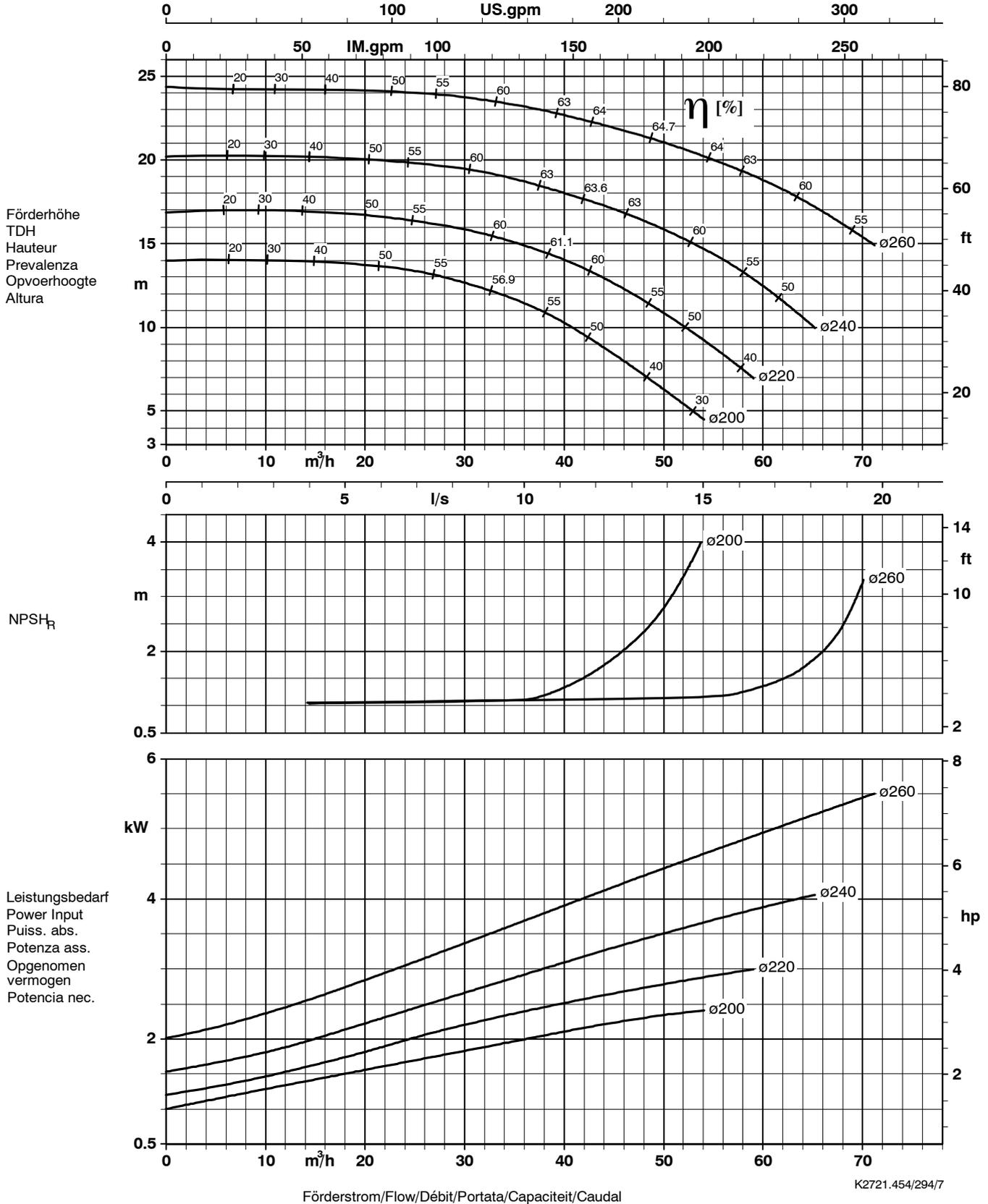
Laufraustrittsbreite/Impeller outlet width/Largeur à la sortie de la roue 13 mm
