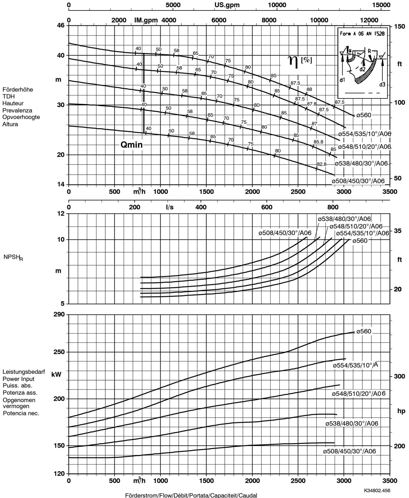
Laufradaustrittsbreite/Impeller outlet width/Largeur à la sortie de la roue 106 mm
