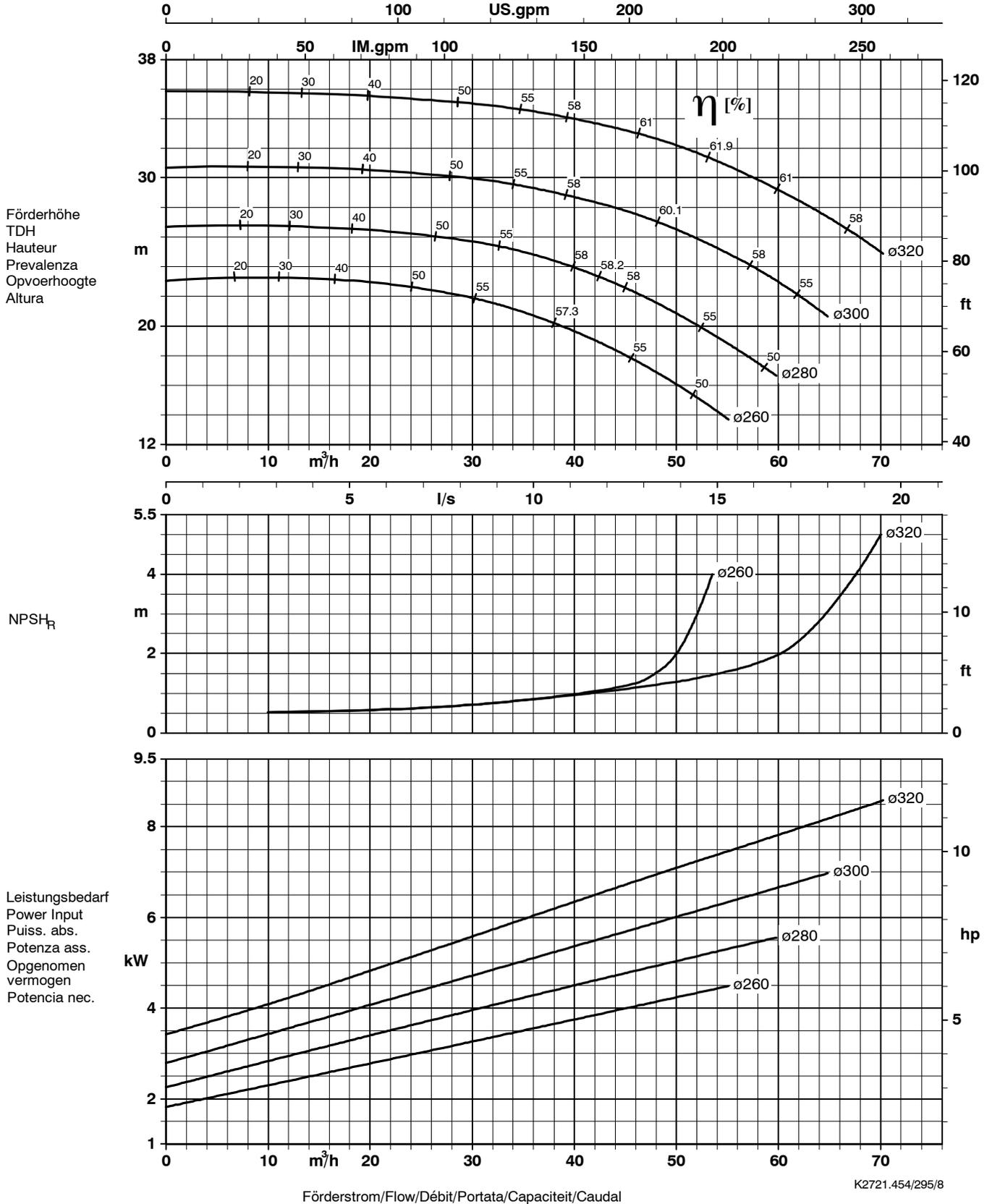
Lauftradaustrittsbreite/Impeller outlet width/Largeur à la sortie de la roue 10 mm
