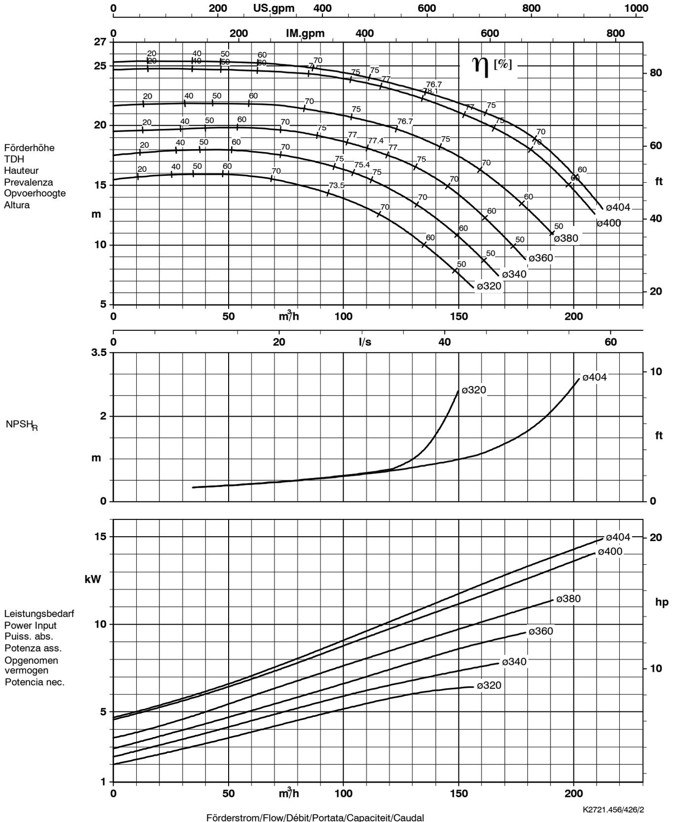
Lauftradaustrittsbreite/Impeller outlet width/Largeur à la sortie de la roue 20 mm
