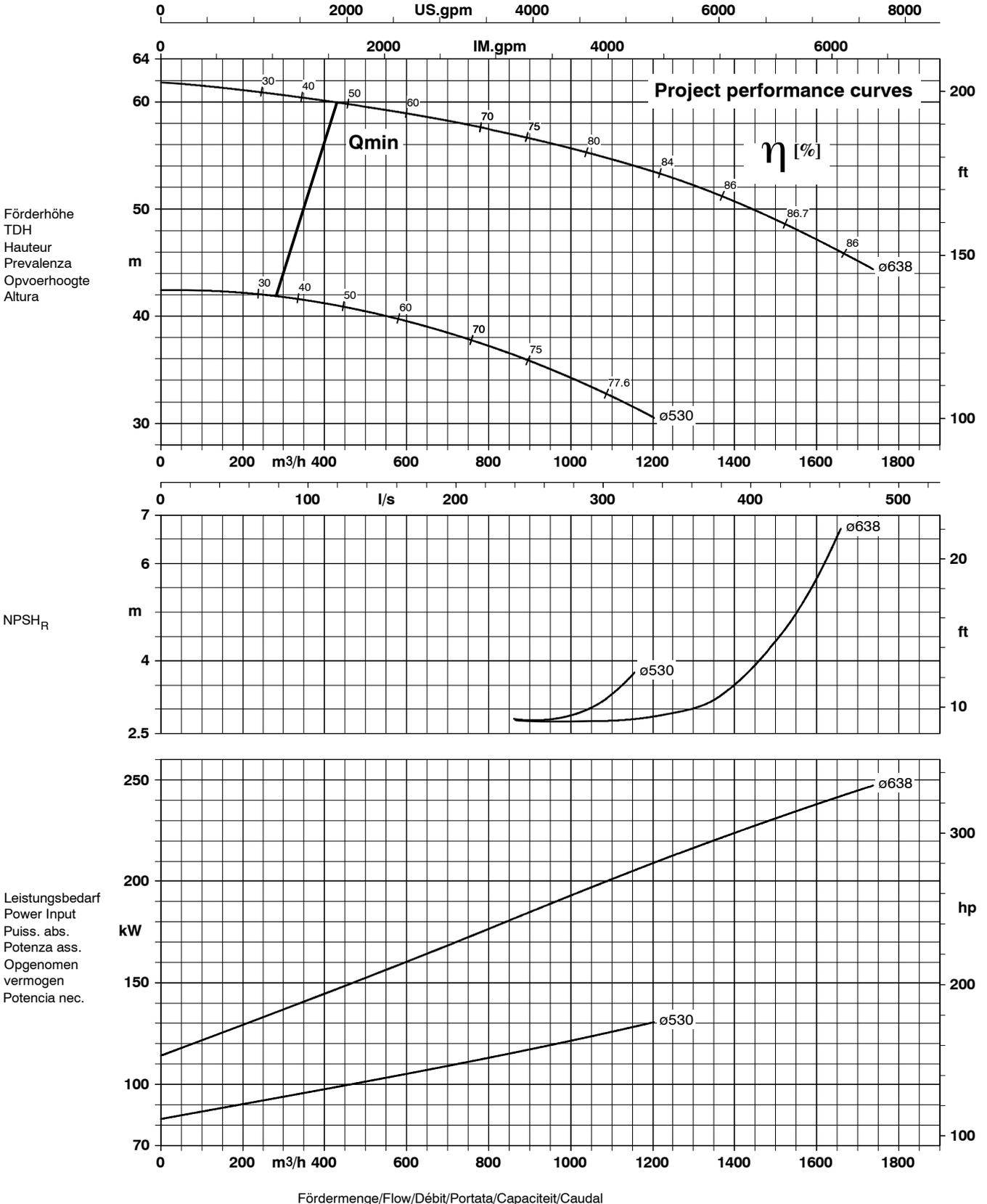
Laufradaustrittsbreite/Impeller outlet width/Largeur à la sortie de la roue 58 mm
