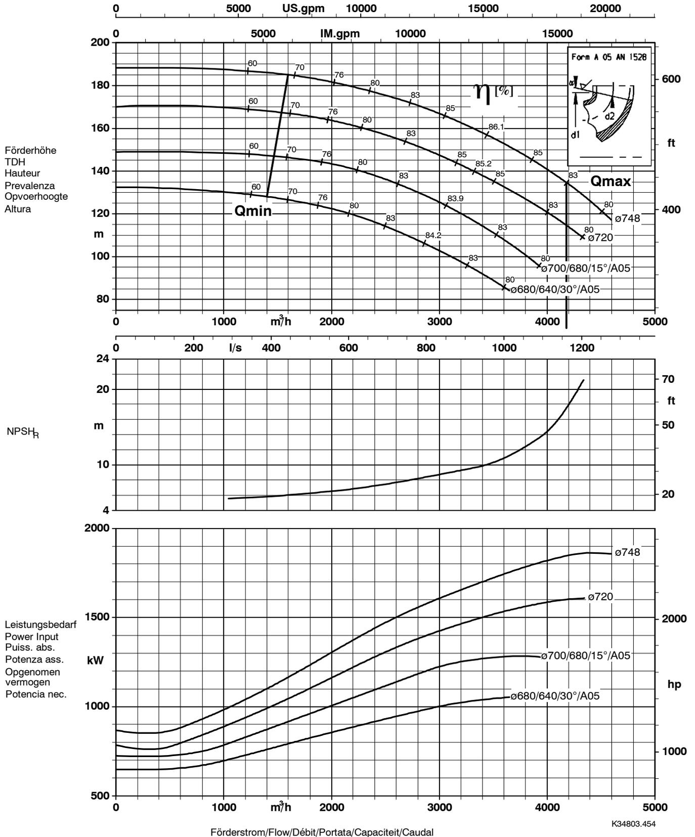
Lauftradaustrittsbreite/Impeller outlet width/Largeur à la sortie de la roue 72 mm
