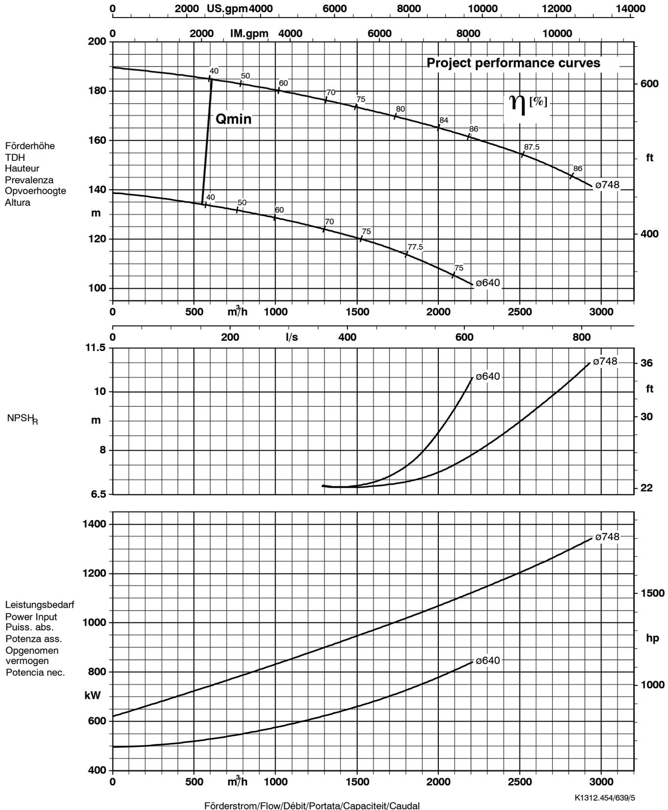
Laufradaustrittsbreite/Impeller outlet width/Largeur à la sortie de la roue 53 mm
