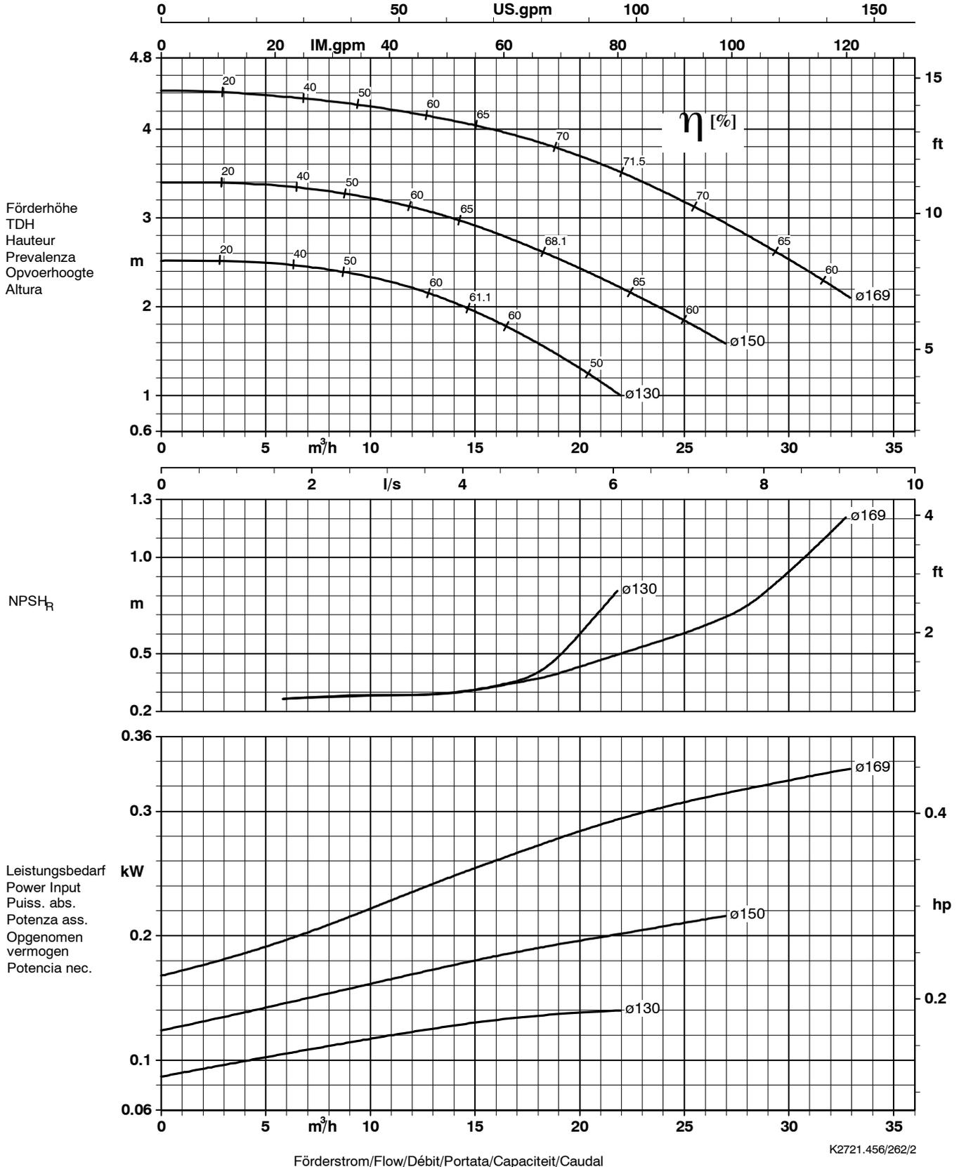
Laufraustrittsbreite/Impeller outlet width/Largeur à la sortie de la roue 15 mm
