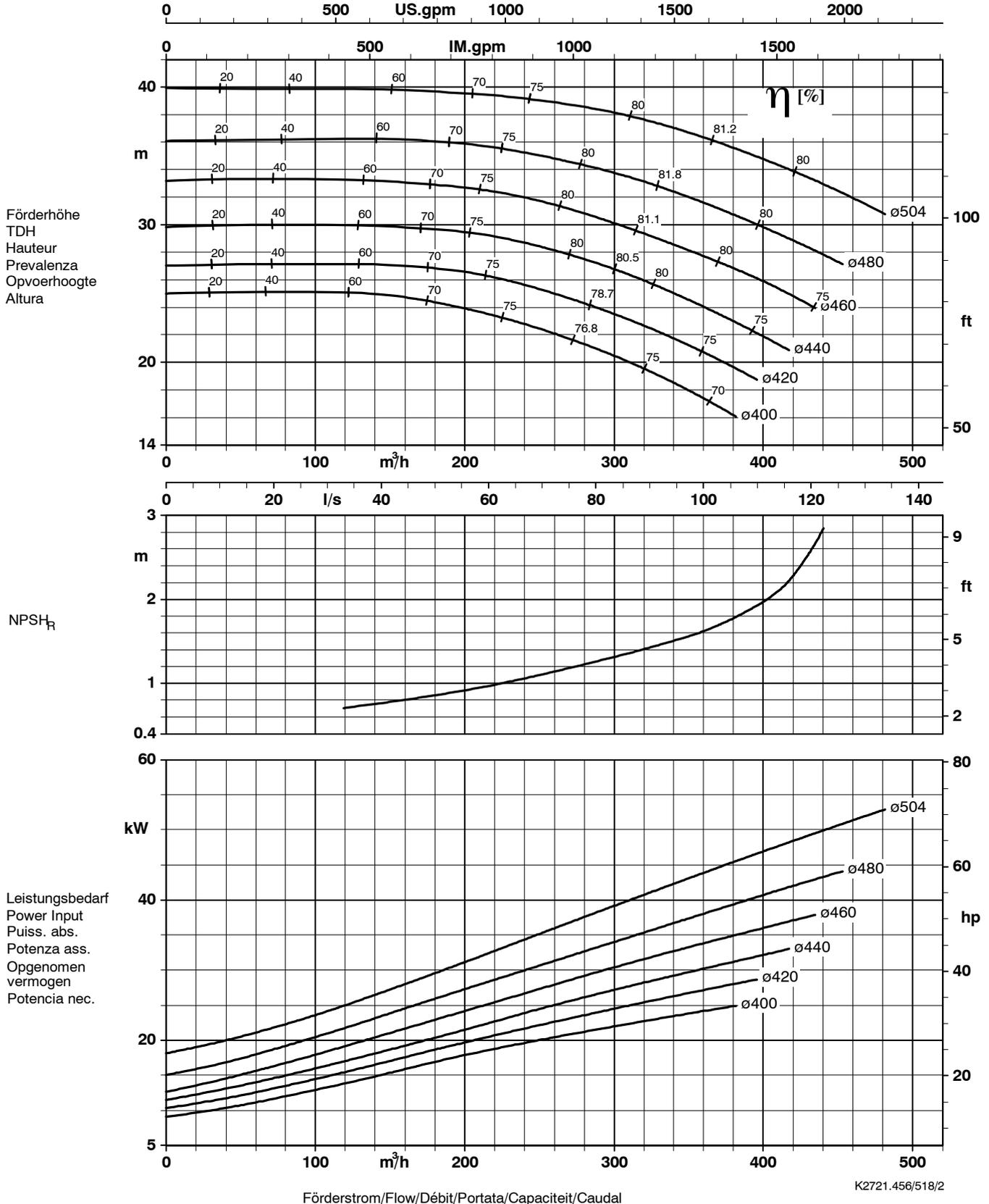
Laufradaustrittsbreite/Impeller outlet width/Largeur à la sortie de la roue 32,5 mm
