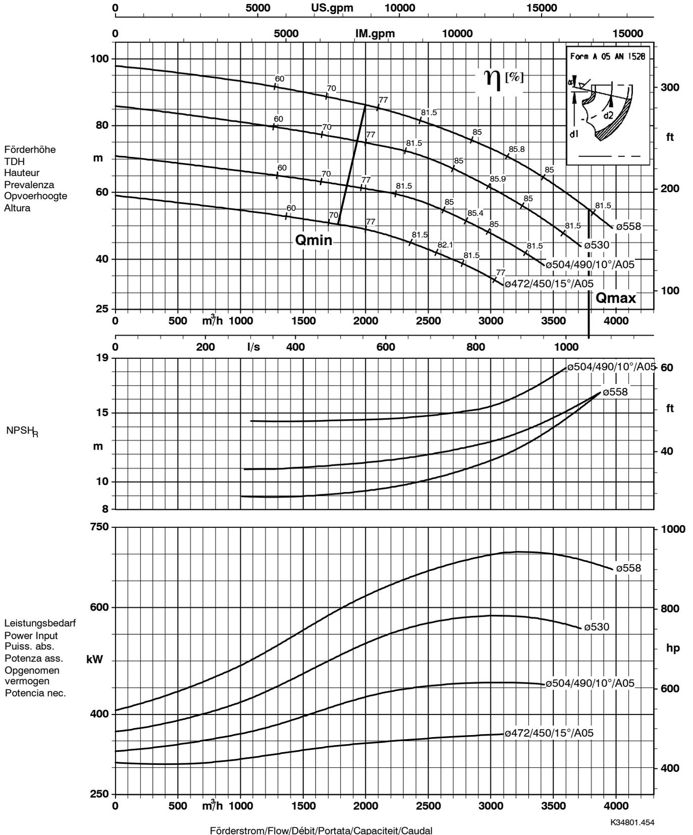
Lauftradaustrittsbreite/Impeller outlet width/Largeur à la sortie de la roue 82 mm
