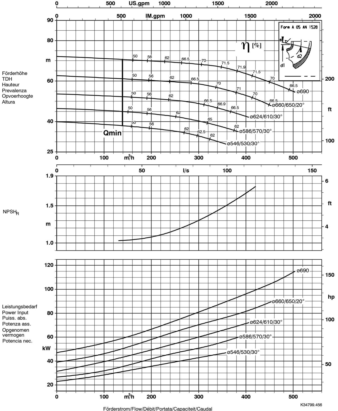
Lauftradaustrittsbreite/Impeller outlet width/Largeur à la sortie de la roue 26 mm
