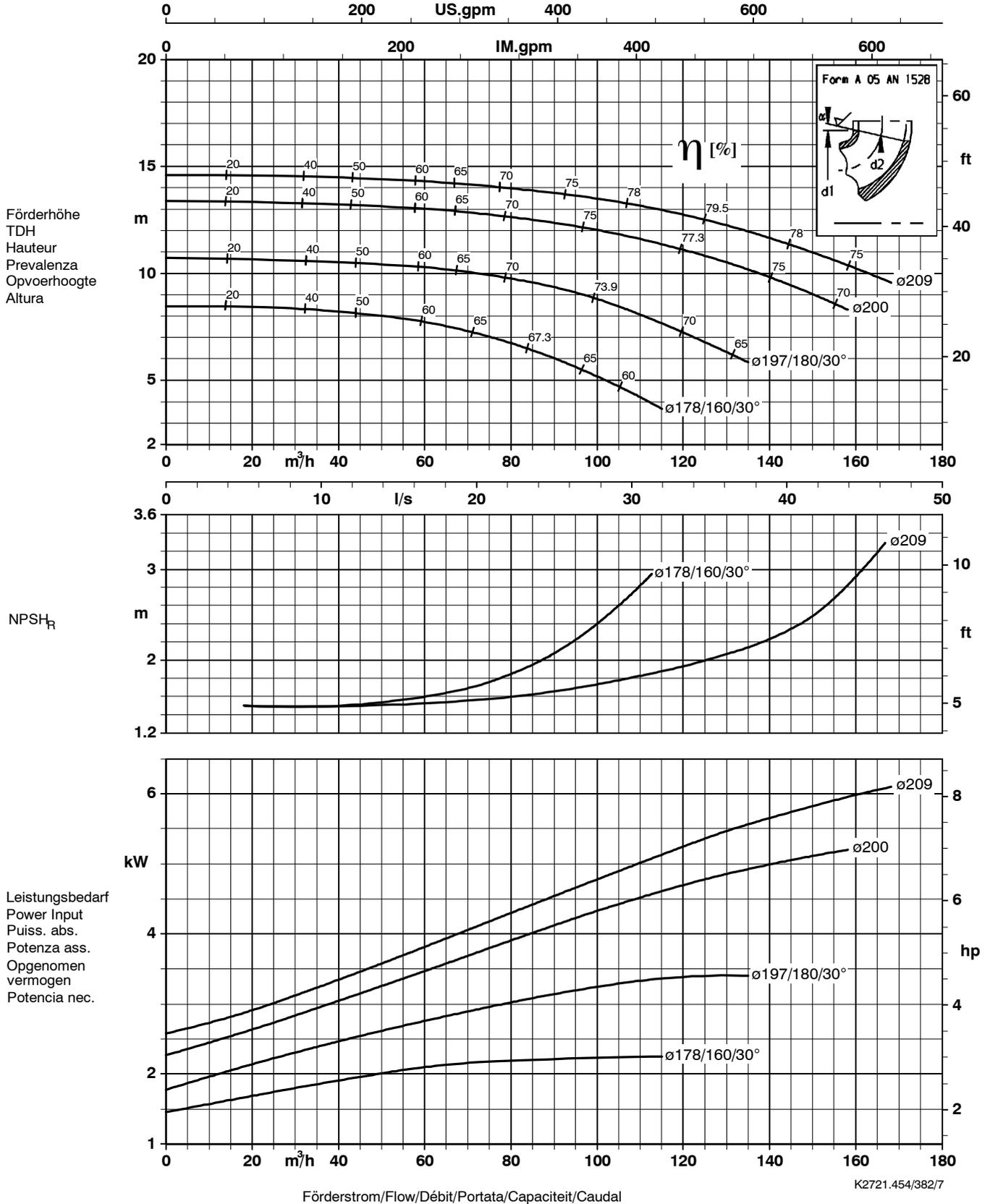
Lauftradaustrittsbreite/Impeller outlet width/Largeur à la sortie de la roue 29 mm
