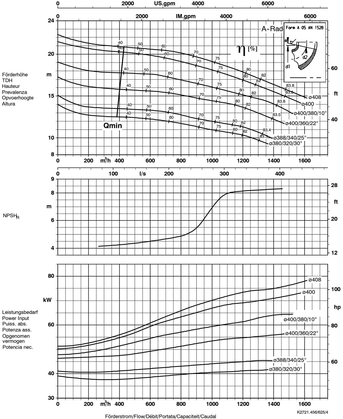
Lauf rad austrittsbreite / Impeller outlet width / Largeur à la sortie de la roue 115 mm
