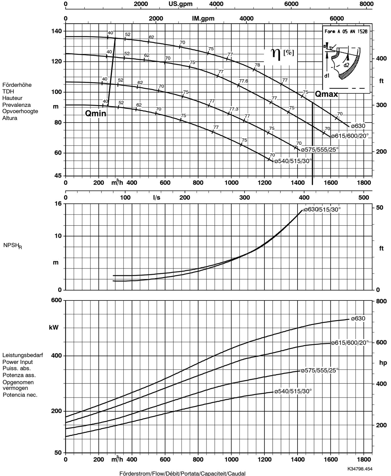
Lauftradaustrittsbreite/Impeller outlet width/Largeur à la sortie de la roue 38 mm
