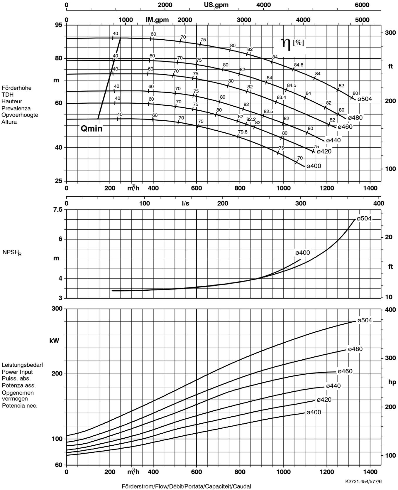
Laufraustrittsbreite/Impeller outlet width/Largeur à la sortie de la roue 43 mm
