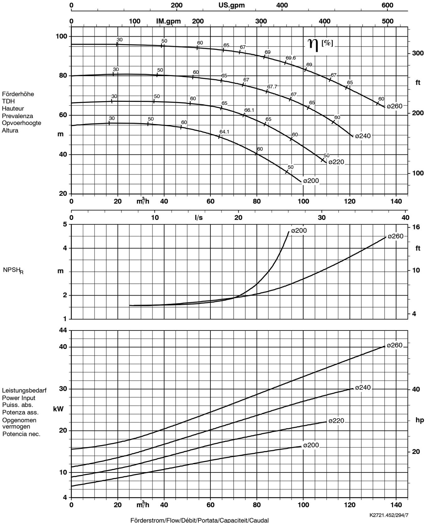
Lauftradaustrittsbreite/Impeller outlet width/Largeur à la sortie de la roue 13 mm
