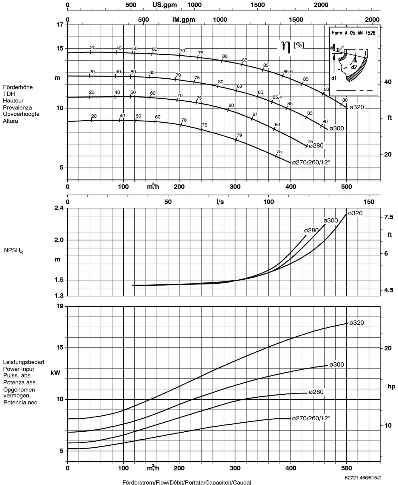
Laufradaustrittsbreite/Impeller outlet width/Largeur à la sortie de la roue 50 mm
